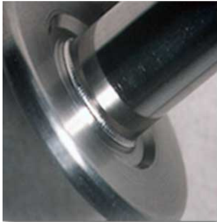
Edelstahlverbindung mittels Laserschweißen
